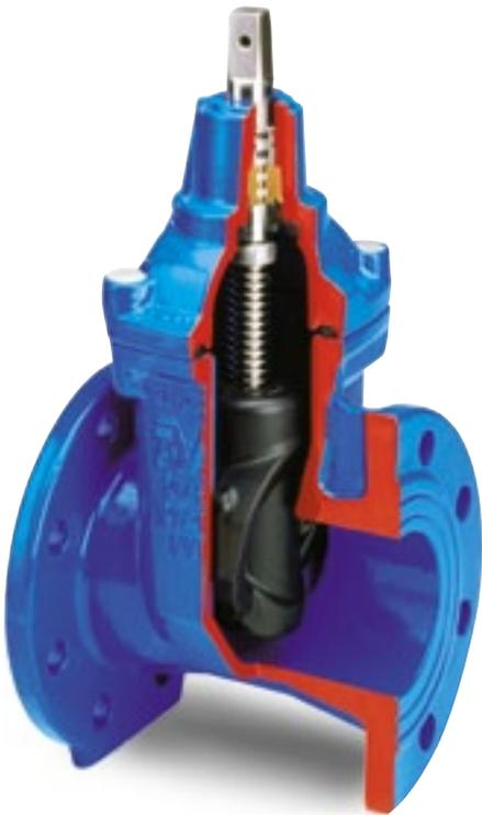
A cunha é o coração da válvula de gaveta e a qualidade da borracha da cunha é crucial para o funcionamento e durabilidade da válvula. As cunhas AVK são totalmente vulcanizadas com composto de borracha de características excepcionais. O processo de vulcanização de dupla adesivação assegura o máximo de adesão da borracha e previne a corrosão dos elementos metálicos.
