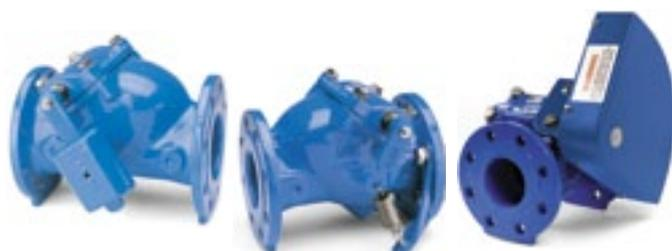
Uma cobertura de proteção sobre a alavanca e peso elimina o risco de ferimentos. Válvulas de portinhola, com alavanca e mola externa são adequadas para alta pressão, contra pressão insuficiente e velocidades de alto fluxo.
